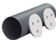
přídavný montážní tubus o délce 500 mm pro RESPIRO 100 N (RD) spojený ke stávajícímu tubusu pomocí spojky SN 100 pro stavby s větší tloušťkou zdi RESPIRO 100 N (RD) přípojevací nástavec
