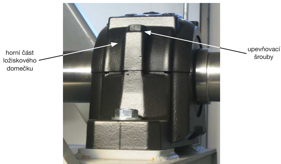
obr. 10.15 - sejmutí horní části domečků ložisek
