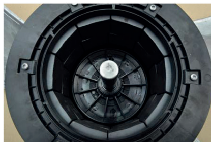
Ocelový rotor s umělohmotným chladicím kolem
