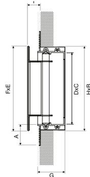
Wanddesign Panel dient der ästhetischen Verdeckung von Belüftungsloch. Abwesenheit des Außenrahmens ermöglicht einen nahtlosen Anschluss an die umgebende Wandgestaltung. Er ist für Zu-, und Abluft geeignet und ist vom Rahmen entfernbar. Panel ist nicht Standardmäßig mit Luftmengenregulierung ausgestattet. Es ist möglich die R1-F-Regelung zu verwenden.
