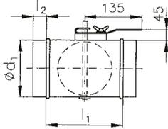
Mit Metall-Handsteuerung und Vorbereitung für Belimo-Servoantrieb.
