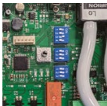
přepínače na desce ventilátoru umožňující nastavení provozních režimů
