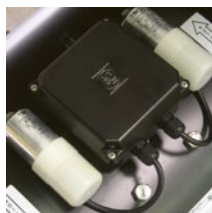
připojení svorkovnice s kabelovou průchodkou PG-11
