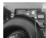
0-10 V / PWM kabel + konektor
