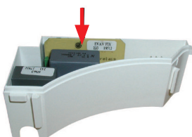
obr. 5 - instalace časového relé
