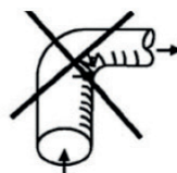
nevhodný způsob montáže
