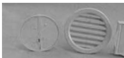
prvky snižující výkon a zvětšující tlakovou ztrátu, pružinová zpětná klapka (pevná součást ventilátoru) a venkovní mřížka jednoho z výrobců
