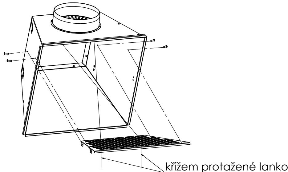
3) konzoli na uchycení čelní desky příšroubovat do připravených otvorů na bocích boxu pomocí přiložených šroubů do plechu a protáhnout lanko skrz otvory na konzoli
