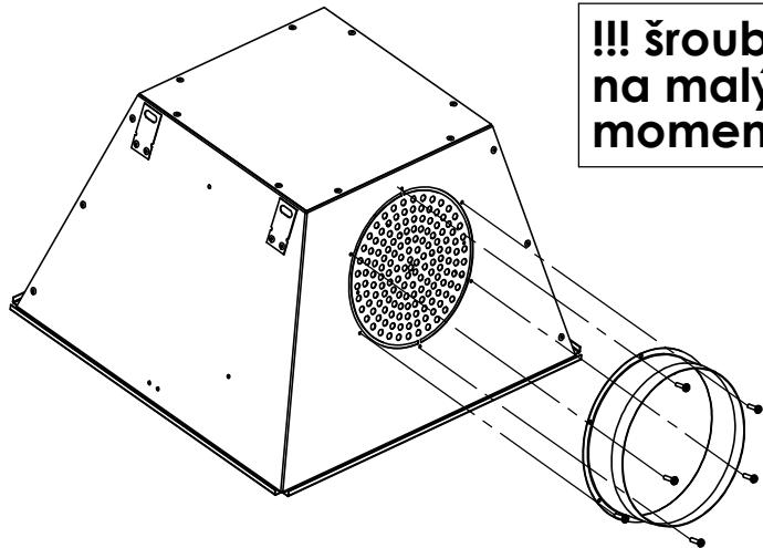
2) rozrážecí plech příšroubovat do připravených otvorů na bocích boxu pomocí přiložených šroubů do plechu a křížem protáhnout lanka skrz otvory v polovině rozrážecího plechu
