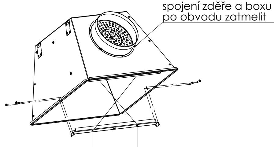
k uchycení boxu na závitové tyče je potřeba ohnout úchyty do horizontálního směru
