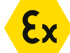
IIG Ex d IIB T4 auf Anfrage IIG Ex d IIB+H2 T4
