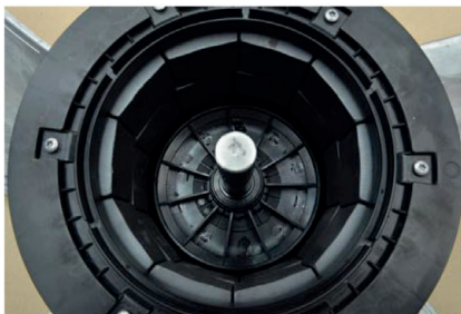
Ocelový rotor s umělohmotným chladicím kolem
