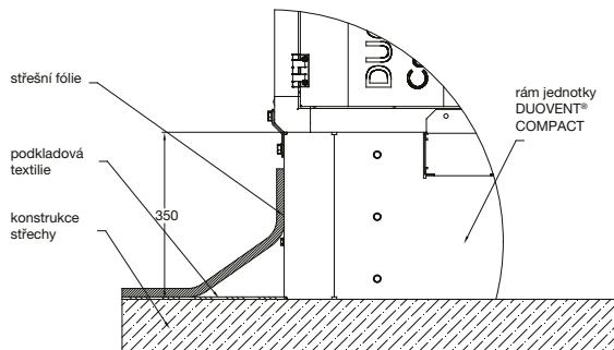
Příklad zabudování podstavného rámu ROOFPACK-B do střešní konstrukce budovy
