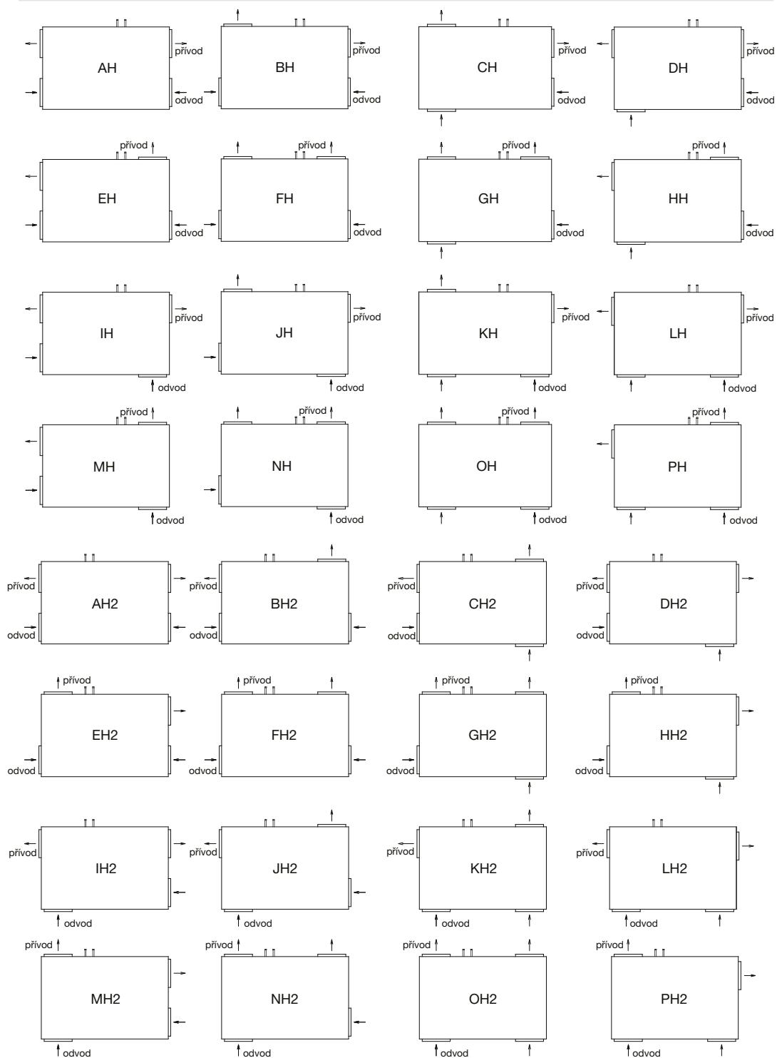
**Varianty hrdel – podlahové horizontální provedení (pohled z horní obslužné strany jednotky)**
