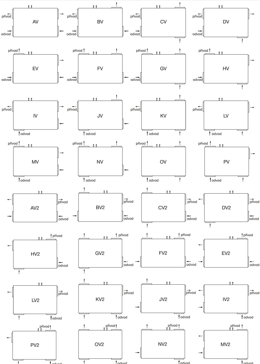
Varianty hrdel – horizontální provedení (pohled z horní neobslužné strany jednotky, půdorys jednotky)
