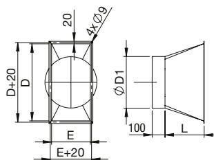
provedení přechodových dílů pro horní a boční výtlaky jednotek (SUP nebo EHA):
