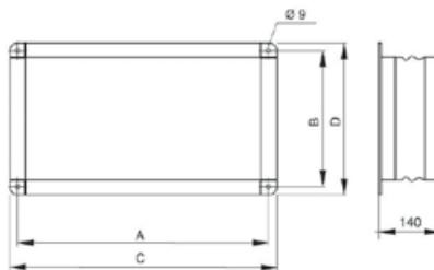
provedení pružných spojek pro horní a boční výtlaky jednotek (SUP nebo EHA):
