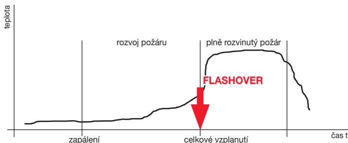
obrázek č. 1 – průběh teploty v požárem zasaženém úseku v závislosti na čase
