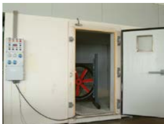
Klimatická komora pro testování ventilátorů při extrémních hodnotách teplot, vlhkosti, slanosti prostředí a UV záření
