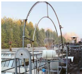
Klimatická komora pro testování ventilátorů při extrémních hodnotách teplot, vlhkosti, slanosti prostředí a UV záření
