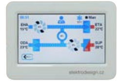
přívodní a odvodní jednotka
