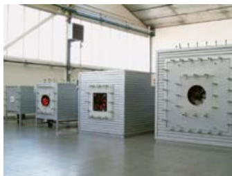
Měřicí tratě pro měření výkonových parametrů ventilá- torů a vzduchotechnických jednotek
