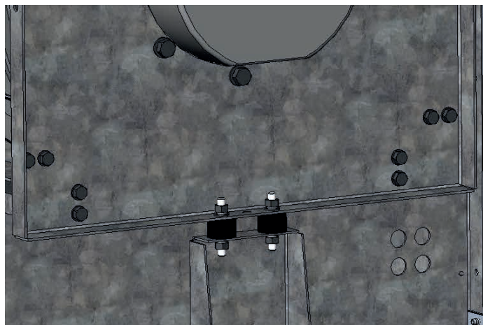
matice M8 (2 ks) silentbloku pod motorem ventilátoru
