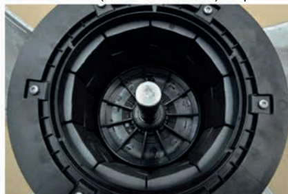
ocelový rotor s umělohmotným chladicím kolem
