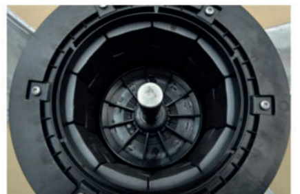
Stahlrotor mit Kunststoffkühlrad.
