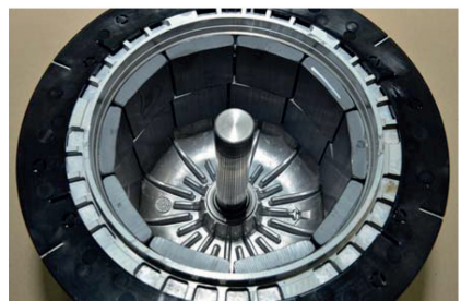
Rotor aus Aluminiumdruckguss mit Kunststoffplatte (nicht abgebildet) am Ring
