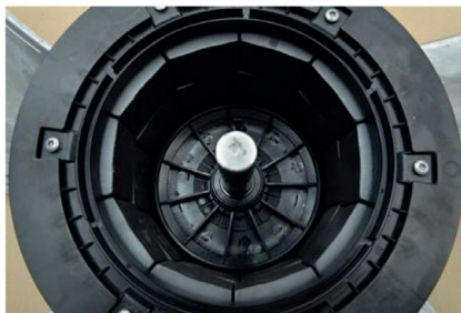
Ocelový rotor s umělohmotným chladičím kolem
