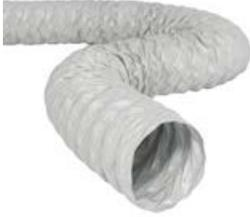
Flexibler Schlauch aus zwei Schichten PVC mit Polyamidgewebe, verstärkt mit einem spiralförmig gewickelten Skelett aus Stahldraht.
