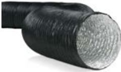
Flexibler Schlauch aus PVC-Schicht mit Polyamidgewebe auf der Oberseite und Al-Laminat auf der Innenseite, verstärkt mit einem spiralförmig gewickelten Stahldrahtrahmen.
