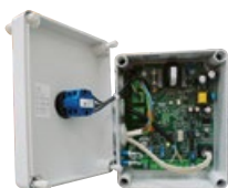
po demontáži víka je vidět digitální regulátor se sériovým rozhraním a konektorem RJ 45 pro připojení programátoru
