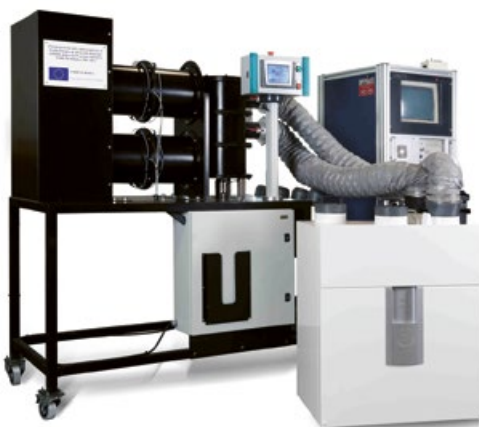
Prüfanlage für die Kontrolle der Parameter von kleinen Rückgewinnungsgeräten, es werden 100 % der Produkte getestet, einschließlich der Archivierung von Daten
