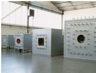
Messstrecke für die Messung der Leistungsparameter von Ventilatoren und Lufttechnikeneinheiten
