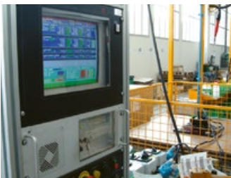
Qualitätskontrolle, es werden 100 % der Produkte getestet einschließlich der Archivierung der Daten
