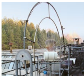
Klimakammer für die Prüfung von Ventilatoren bei extremen Werten von Temperatur, Feuchtigkeit, salziger Umgebung und UV-Strahlung
