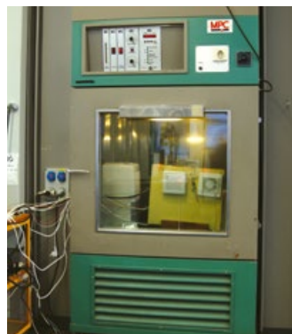
Klimakammer für die Prüfung von Ventilatoren bei extremen Werten von Temperatur, Feuchtigkeit, salziger Umgebung und UV-Strahlung
