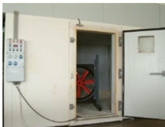
Klimakammer für die Prüfung von Ventilatoren bei extremen Werten von Temperatur, Feuchtigkeit, salziger Umgebung und UV-Strahlung
