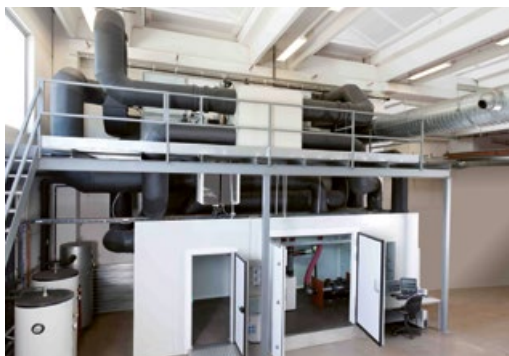
Klimakammer für die Prüfung von Rückgewinnungsgeräten
